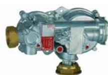
Régulateur Gaz Naturel 6 m<sup>3</sup>/h, entrée 0,3 à 4 bar, sortie 21 mbar, écrou 3/4 sphero conique, écrou 8/20, compteur.
