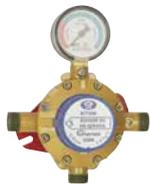
Il assure la continuité de l'alimentation en gaz dans l'installation par le passage automatique de la bouteille vide à la pleine. Il réalise la 1<sup>re</sup> détente de l'installation. Pression amont maxi 8b.
